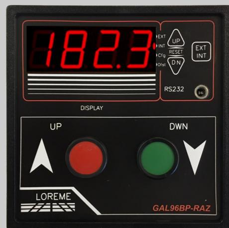
Le GAL96BP est un générateur de point de réglage avec boutons d'ajustement ou par entrées numériques. Il permet le basculement entre une entrée de point de réglage externe et un point de réglage local avec un bouton de face. Le point de réglage local charge la valeur de point de réglage externe lorsque le basculement se fait vers le réglage interne (éviter les glitch dans le signal de sortie).
